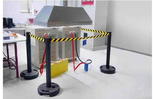
Durch die feinere Bauweise von Lithium Batterien (dünne Materialien, chemisch reaktivere Materialien) sind diese bei Beschädigungen anfälliger für Kurzschlüsse. Die daraus entstehenden Gefahren müssen begrenzt werden. Zu diesem Zweck verwendet man heute Batterie-Managementsysteme unterschiedlichster Bauart, von einfachen Schutzbeschaltungen bis hin zu komplexen Strom-balancierenden und einzelne Zellen überwachenden Minicomputer.
